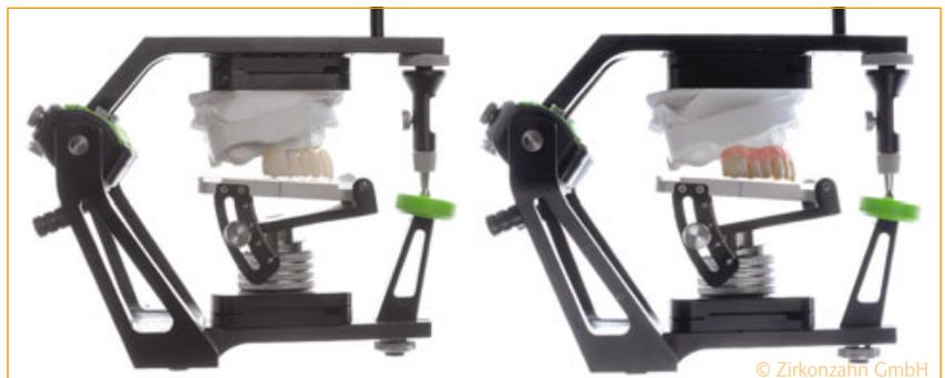
Abb. 43 Ob die Okklusionsebene mit der neuen Zahnmodellation richtig verläuft, kann jederzeit am Artikulator PS1 überprüft werden.
