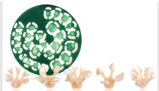
Abb. 11: Die Einzelteile wurden aus Wachs gefräst, über die Presstechnik in Lithium-Disilikat-Glaskeramik überführt und anschliessend fertiggestellt.
